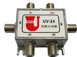
數位電視四路分岐器 UV-24 幹線損失為 -3dB 支線損失為 -14dB
