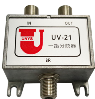
數位電視一路分岐器 UV-21 幹線損失為 -3dB 支線損失為 -8dB
