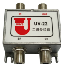
數位電視二路分岐器 UV-22 幹線損失為 -3dB 支線損失為 -12dB
