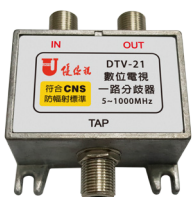
數位電視一路分歧器 DTV-21 幹線損失為 2dB 支線損失為 8dB
