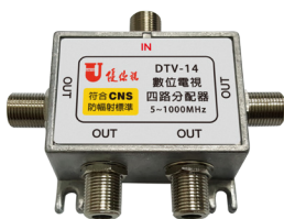
數位電視四路分配器 DTV-14 分配損失為 8dB
